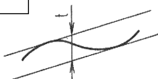
Toleranční pole přímosti
